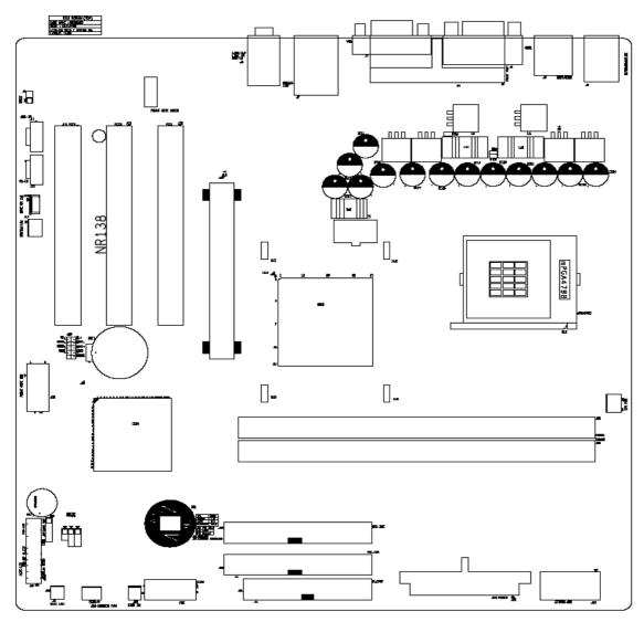
Figure 1-2. SCENIC Edition X101-Mainboard Layout Diagram
